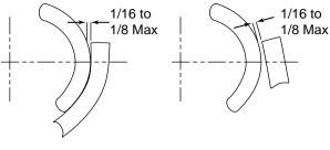
Figure 16. Root Weld Gap
